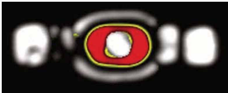
图4: 在聚光透镜表面被研磨成平面后, 对这种微小LED的顶层进行超声成像可以揭示从基板到聚合物透镜层之间所存在的全部分层缺陷。
