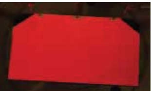
图3: 对顶部的接面进行偏置,它所产生的电致发光可以用来评估该接面的均匀性及其材料质量。
