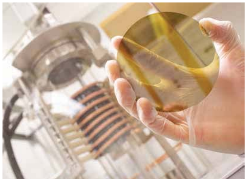
SiC 生长系统方面的经验为大面积石墨烯的生长制备提供了巨大的潜力
