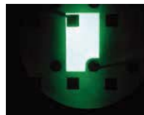
在(20 \bar{2} 1)晶面上制作的LED具有稳定发射峰值的绿光
