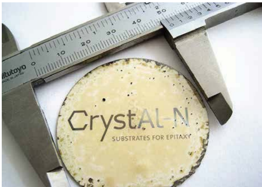
虽然只是刚刚宣布推出 2 英寸 AlN 衬底，但是 CrystAL-N 公司已经放眼于生长 4 英寸材料了。 照片提供者：CrystAL-N 公司。
