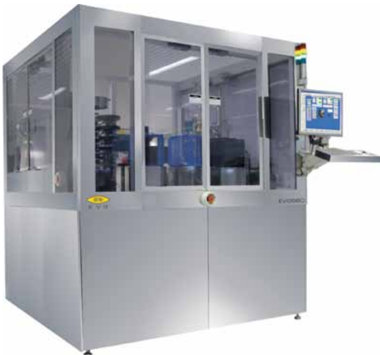
图3: EVG560HBL工艺设备可以进行全自动和半自动化操作，它可以支持金属、不同衬底类型的粘接性和熔接性键合。EVG公司宣称它非常适用于发光二极管 (LED) 的大批量生产制造，这是因为它结合了由片盒到片盒的操作，多层衬底的键合能力，以及拥有多达四个交换插入式工艺模块为特征的模块化设计。根据设备制造商的说法，设备采用了经生产现场验证的晶圆键合技术和一个独特的低温金属晶圆键合相组合的方法，使其具有前所未有的高生产能力和产量。
