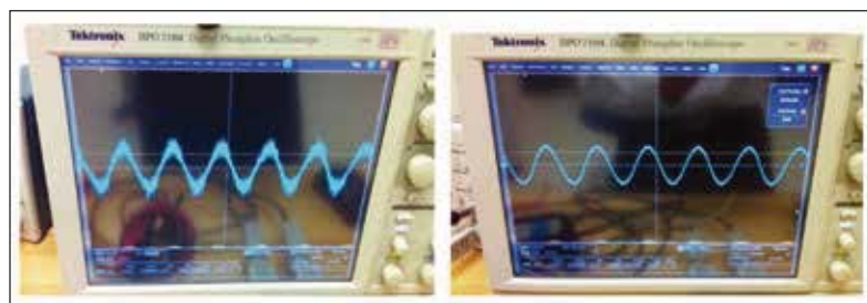
图4：逆变器产生的波形，硅 IGBT 器件的输出波形（左图）与 Transphorm 的 GaN 器件（右图）相比具有更加明显的噪声。
