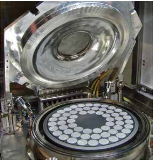
VPE GaN-500具有新颖的气体喷射器/反应室结构，图中可以看到喇叭口状的顶盖内壁和多喷口气体喷射器。
