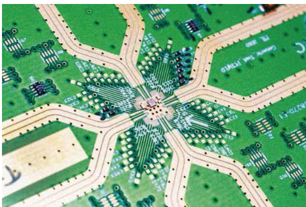
imec 的连续波雷达发送器采用 28nm CMOS 工艺实现，具有 0.9V 的电源电压，其功耗仅为 121mW 且完全符合 ETSI 强制的频谱掩模标准。（照片由 imec 提供）
