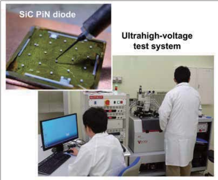
图9. 正在进行高压测试的二极管
