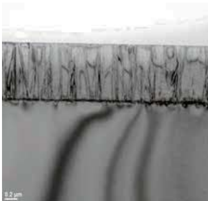
横截面的透射电镜表征揭示在 SOI 衬底顶部硅层中的应力受到了 AIN 层的抑制。
