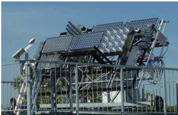
图1：位于Fraunhofer 太阳能研究所屋顶上的太阳光跟踪装置。利用各种气象传感器可使CPV模块在 \pm 0.1^\circ 的精度范围来连续跟踪太阳光的入射角度。
