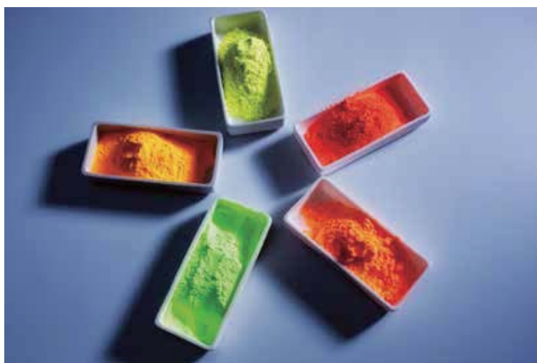
图1：Intematix 生产的荧光粉材料，包括基于 YAG、硅酸盐、氮化物和铝酸盐的荧光粉材料。
