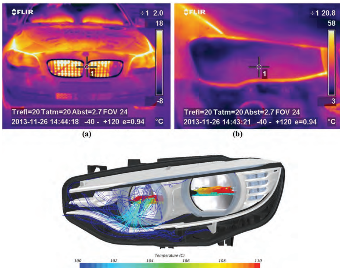
图5. (a)发动机启动后一辆宝马车前引擎盖上的温度分布。(b)前照灯周围的温度分布。(c)LED前照灯内部的温度，其最大值可达110 °C。
