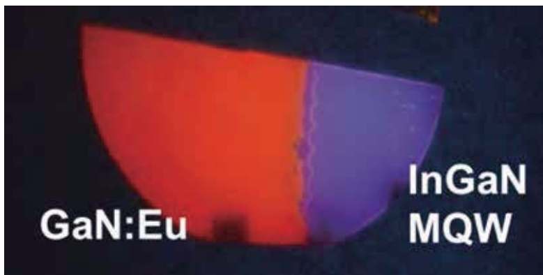
图4. 在同一LED晶圆上蓝光和红光发射区域的单片集成。
