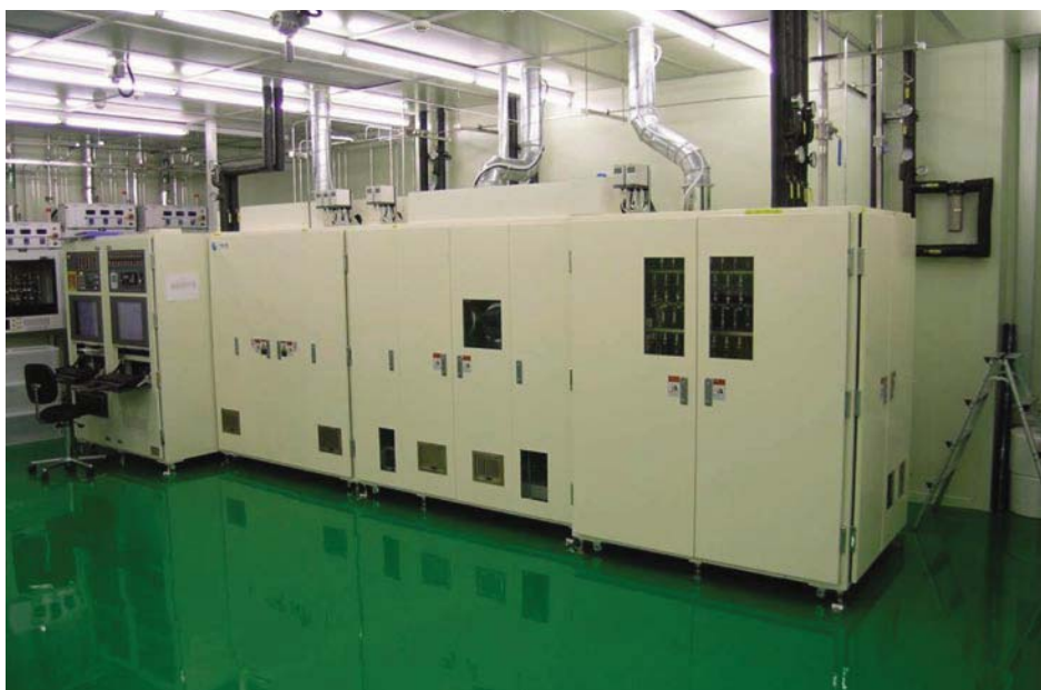
圖一：LED結構被製作於具有三個2吋晶圓能力之太陽日酸SR - 4000的機台上
