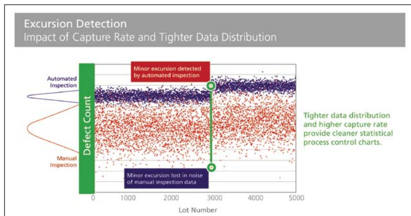
圖四：人工檢查引入了大量的雜訊到任何測量。其結果是當使用人工檢查時偏差會被忽視的，但採用自動檢查時很容易被察覺
