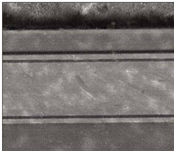
圖二：掃描電子顯微鏡SEM的剖面觀察照片，突出顯示了在進行Au:Sn晶圓共晶接合後，InP和GaAs晶圓間高質量的介面結合。
