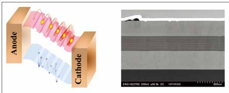
图2. (a) 将一个相对较弱的磁场应用到一个具有周期性叠加的 GaN/AlN 结构的 APD 上, 使电子能量能够达到 5.3 eV 的电离阈值。(b) 透射电镜揭示这种分子束外延 (MBE) 生长结构具有高质量。
