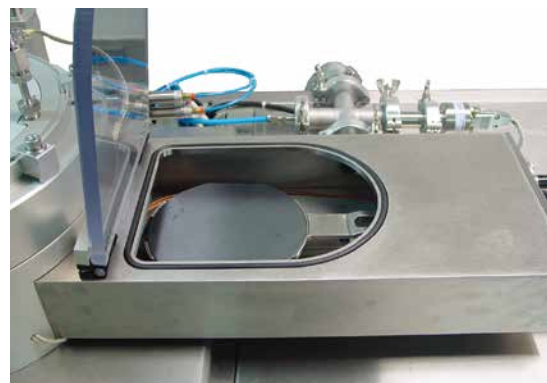
为了防止氧化，晶圆在生长后被放置于闭锁的预真空室中，进行氮气冲洗和冷却。
