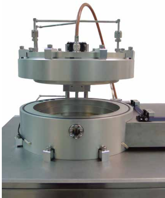
由于衬底与泵室间的间隙非常小，平面电感等离子体耦合系统能大大缩短抽真空的时间。
