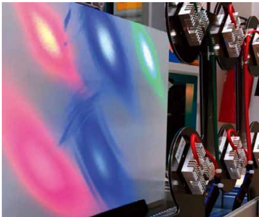
图5. 2017年显示周展示的Exalos演示，将红绿蓝激光二极管（顶部）与Exalos的红色和蓝色SLED（底部）进行了比较。
