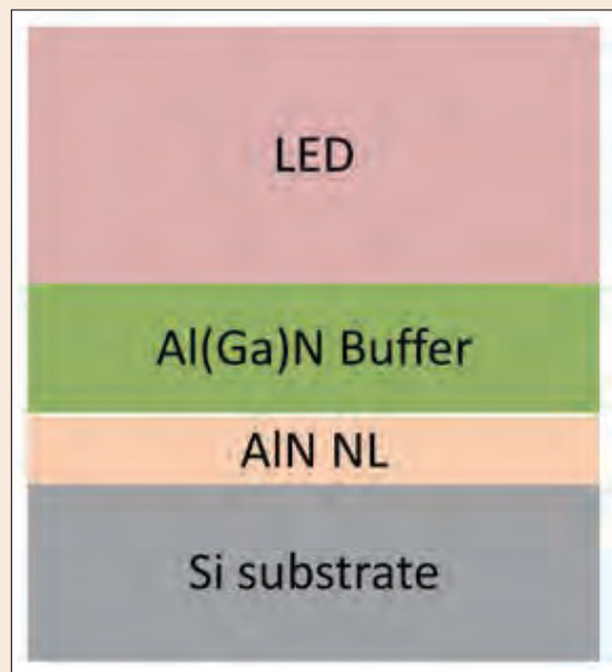
图1. 晶湛半导体公司用于在 200mm 硅片上制作器件的 LED 外延结构。
