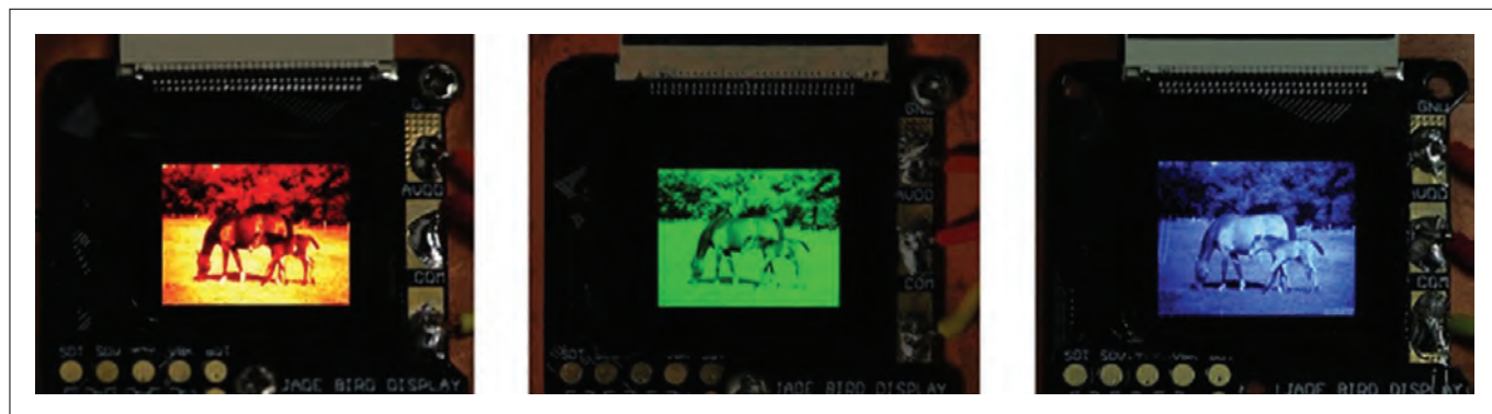
图2.封装好的红色、绿色和蓝色有源矩阵microLED微显示器。
