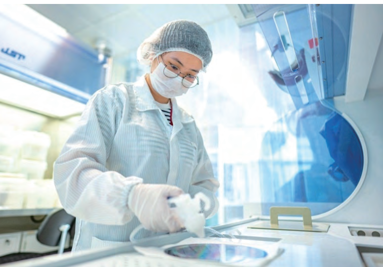
图1. LEES 研究人员审查 200 mm 硅 III-V 晶圆片。LEES 开发的创新和商业就绪工艺利用现有的 200 mm 半导体制造基础设施来制作新一代芯片，将传统的硅与 III-V 器件相结合，而这以前在商业上是不可行的。
