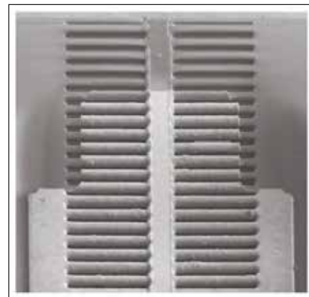
沙特阿拉伯国王科技大学的工程师通过给商用激光器增添表面光栅，制作了一款窄线宽绿光激光器。
