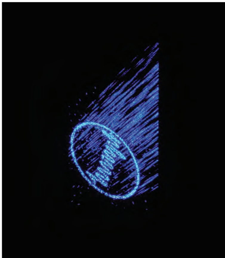
2019年5月，Plessey推出了具有1920x1080电流驱动型单色像素（像素间距为8μm）阵列的microLED显示器。每个显示器需要200多万个单独的电粘接，以将microLED像素连接至控制背板。
