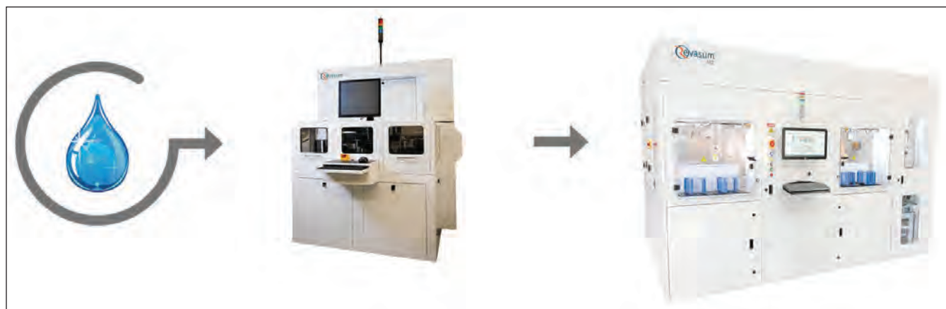
图2. 典型的单晶圆工艺序列需要研磨机和抛光机，每个机器都带有集成的清洗模块。
