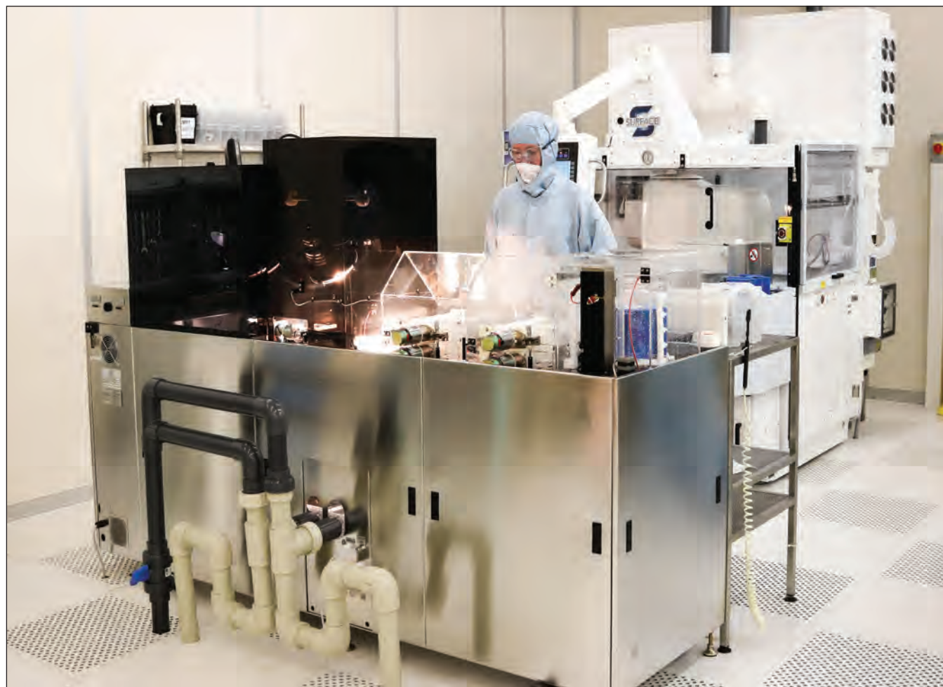
显示器的生产中会使用硅基氮化镓外延片的化学机械研磨工艺。为了减少发生颗粒污染的机会，在设备上使用了有机玻璃挡板。
