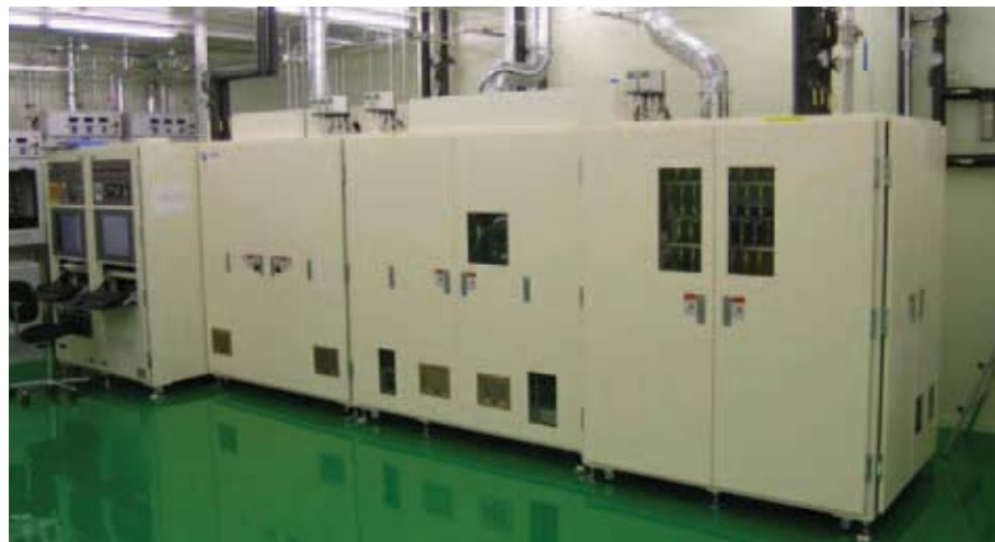
图1: 在具有三个2英寸晶圆能力的太阳日酸SR-4000的机台上制作LED结构
