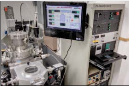
照片为安装在Lakehead大学中的Meaglow反应器原型，显示了其中的不锈钢超高真空（UHV）生长室（左图）和计算机电子控制系统（右图）。
