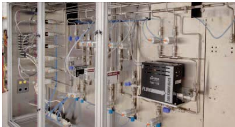
用于Meaglow反应器的金属有机物蒸汽运输系统。由于大多数金属有机物蒸汽不需要再使用~1 毛左右气压的载气——相对于传统的MOCVD系统，这样就能大大简化蒸汽的运输系统。
