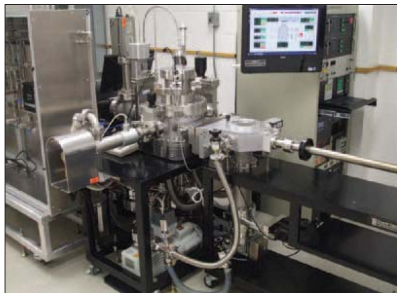
标准Meaglow反应器原型设备的一个宽幅照片，显示了具有真空装载锁的超高真空（UHV）中央生长室，还配置了残余气体分析（RGA）和反射高能电子衍射（RHEED）分析室、金属有机物（MO）蒸汽运输系统（图中左侧）和相应的电子控制设备（图中右侧）
